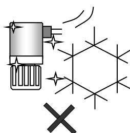
腐食性、揮発性ガスが噴出している所
