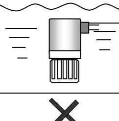
継手が天面を向く取り付け方
