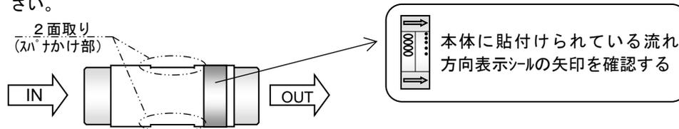
③PTおねじの締付けは本体部の2面取り部にスパナをかけて締付けてください。
